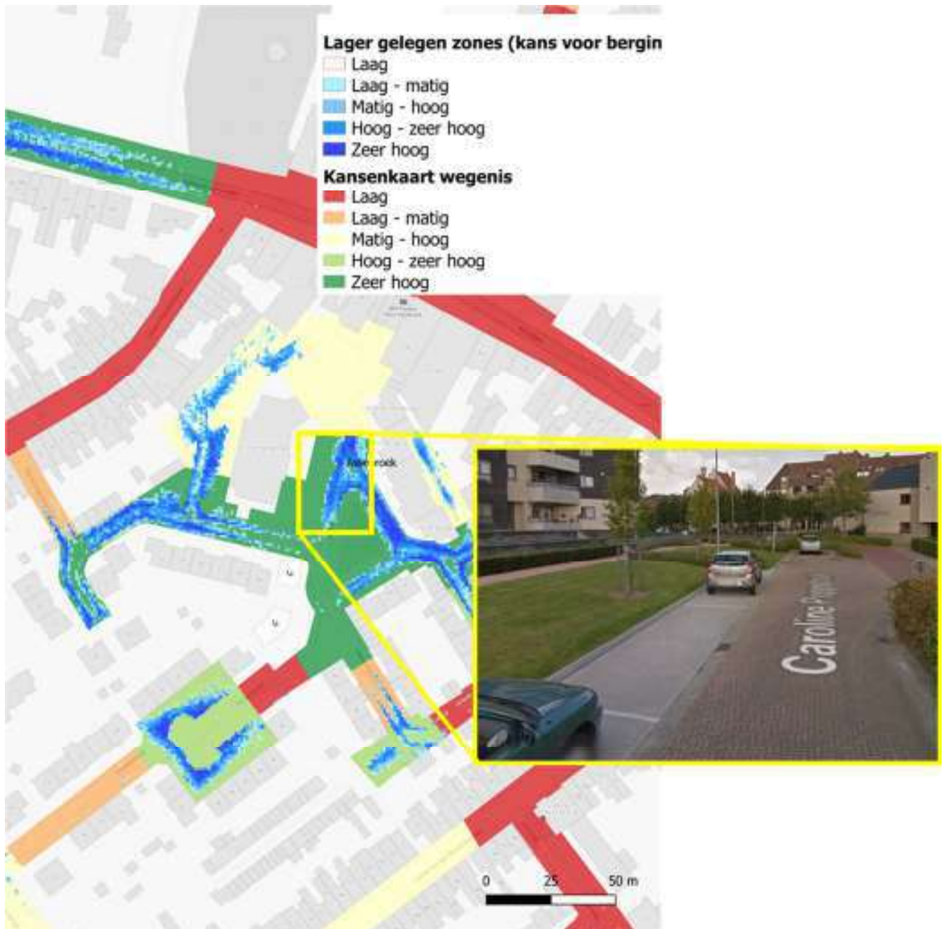
Figuur 18: Zoom naar de Caroline Poppstraat in Assebroek. De lager gelegen wegdelen zijn aangegeven in de rood gekleurde pixels. De kleur van het ganze wegsegment toont het potentieel van de wegbaan en maakt snelle lokale vergelijkingen tussen wegsegmenten mogelijk.
