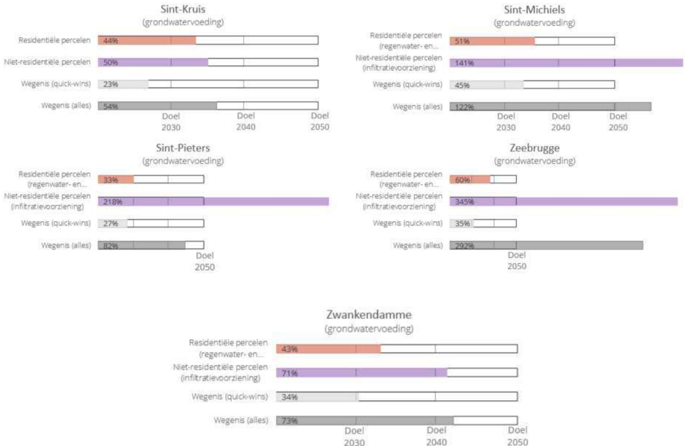
Figuur 31: Samenvatting van de impact van scenario's op de wateruitdaging droogte. De scenario's "residentiële percelen", "niet-residentiële percelen" en "wegenis (alles)" gaan uit van een maximale implementatiegraad. Het scenario "wegenis (quick-wins)" houdt enkel rekening met de geïdentificeerde kansen voor (slimme) ontharding.
