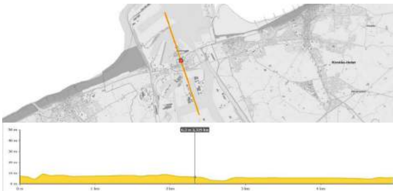
Figuur 9-1: Hoogtemeting met profiel ( www.geopunt.be )
