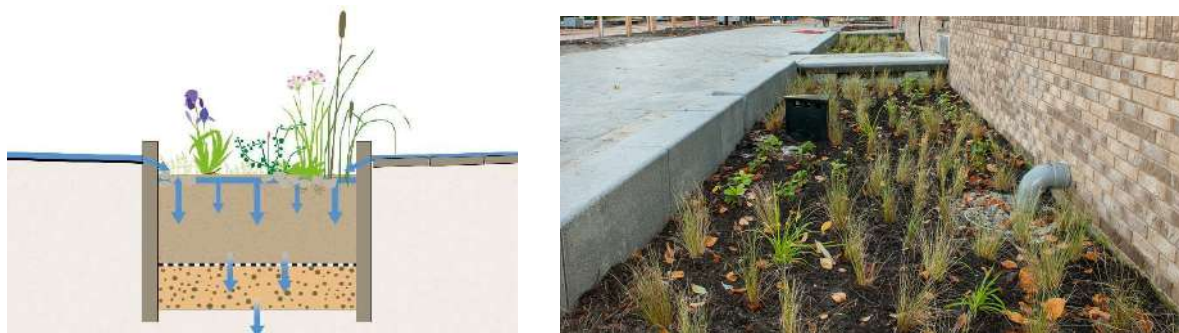
Figuur 8. Principes en voorbeeld van infiltratiestroken langs wegen.
