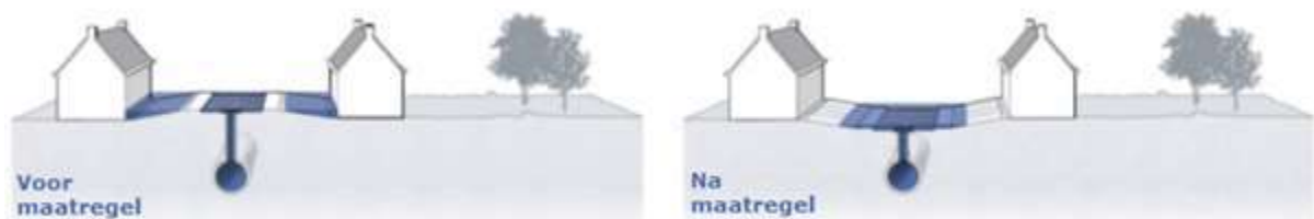
Figuur 11. Schade beperken bij water op straat via verdieping van de straat / door het straatprofiel lager en "hol" aan te leggen i.p.v. "bol". (Bron: RIONED)
