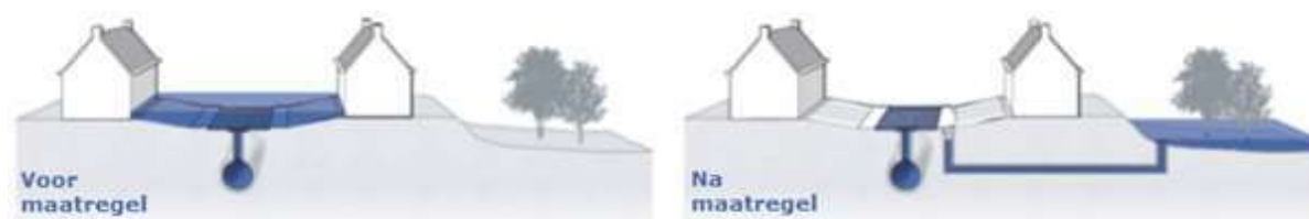
Figuur 9. Ontlasting van de riolering via regenwaterberging en infiltratie in open Klimaat- & water-robuste (her)inrichting van stedelijke ruimtes met meer groen en blauw tussen of in de plaats van het grijs. (Bron: RIONED)
