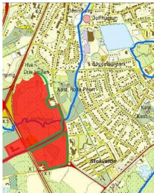
Figuur 22: Inrichting van een gecontroleerd overstromingsgebied langs de Kerkebeek in Sint-Michiels (bron afbeelding: VMM).
