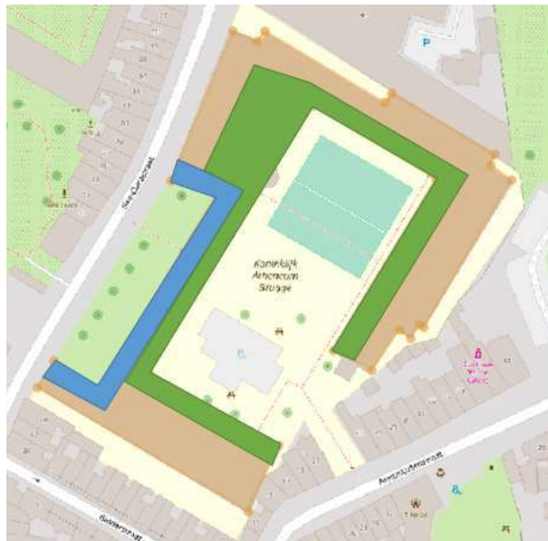
Figuur 36: Aanduiding van de dakdelen die aangesloten worden op een hemelwaterput in de analyse.
